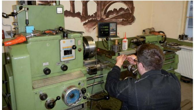
*Simeon Langenbahn beim Einbau neuer Messwertgeber an der Drehbank.*
