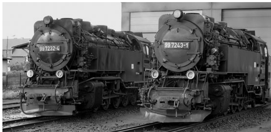
99 7232 (links) ist die erste Einheitslok dieser Baureihe mit neuem Blechrahmen. Hier neben der Schwesterlok 99 7243 im BW Wernigerode.
