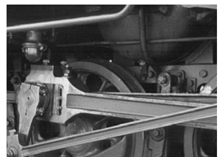
99 222: Treibachse mit geschwächtem Spurkranz
