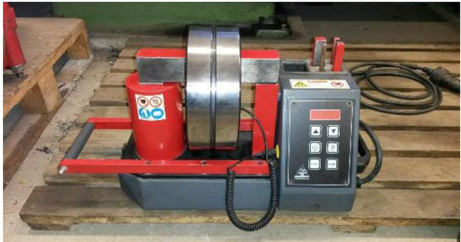
▲ Der Innenring eines neuen Radsatzlagers wird zur Montage auf der Radsatzwelle mit einem Induktions-Anwärmgerät erhitzt.
