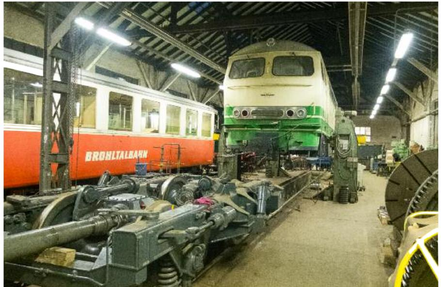
▲ Lok D5 ist inzwischen wieder auf Gleis 12 der Brohler Werkstatt aufgebockt, die Drehgestelle wurden ausgefahren. Dies ist für Arbeiten am Maschinenraumfußboden im Zuge der bevorstehenden Remotorisierung erforderlich. Foto: Simeon Langenbahn
