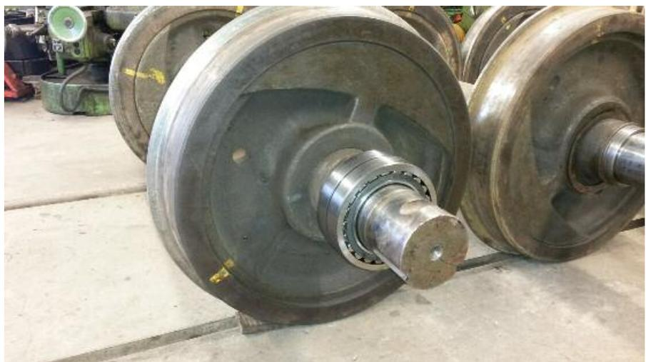
▲ Die Montage des Radsatzlagers ist abgeschlossen. Es wird axial zusätzlich durch die noch zu montierende Gegenkurbel gesichert.
