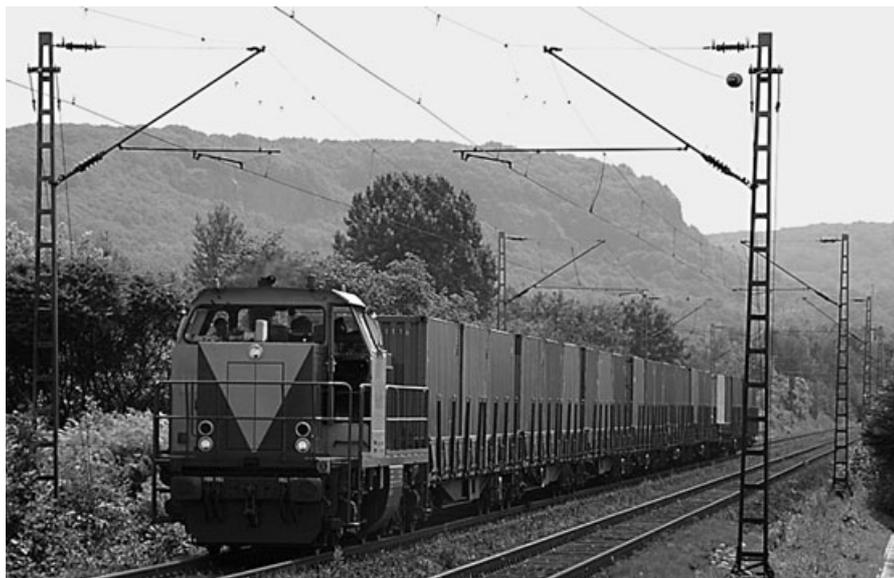
Containerzug der Brohltalbahn mit Lok „Josy“ des Typs DH 1004 der Rurtalbahn auf dem Weg nach Bremerhaven. Der Loktyp DH 1004 ist durch Umbau aus der DB Baureihe 211 entstanden. Der Umbau wurde durch die Firma Vossloh Schienenfahrzeugbau in Moers nach Plänen von On Rail durchgeführt. Die Rurtalbahn besitzt 3 Maschinen dieses Typs. Foto: C.Schumacher
