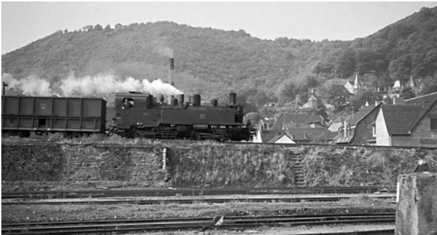
Ankunft des Lavazuges im Umladebahnhof Brohl (2. Halbjahr 1964). Nach einer Sägefahrt mit Umsetzen wird Lok 11<sup>sm</sup> die Fuhre weiter zum Hafen auf das Sturzbunkergleis schieben. Foto: Walter Steingahs
