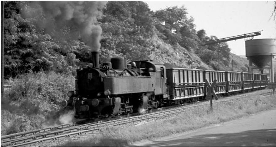
Güterbahnhof Weiler 1965. Die Selbstentlader Typ "Schwefer" sind schon fast komplett mit Lava vom Herchenberg befüllt. Lok 11<sup>sm</sup> wird in Kürze umsetzen und den Zug zum Hafen Brohl fahren. Foto: Sammlung Theodor Horn
