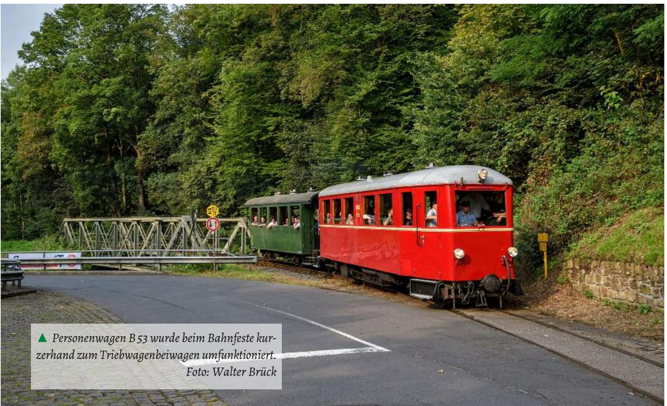
▲ Personenwagen B 53 wurde beim Bahnfeste kurzerhand zum Triebwagenbeiwagen umfunktioniert.
