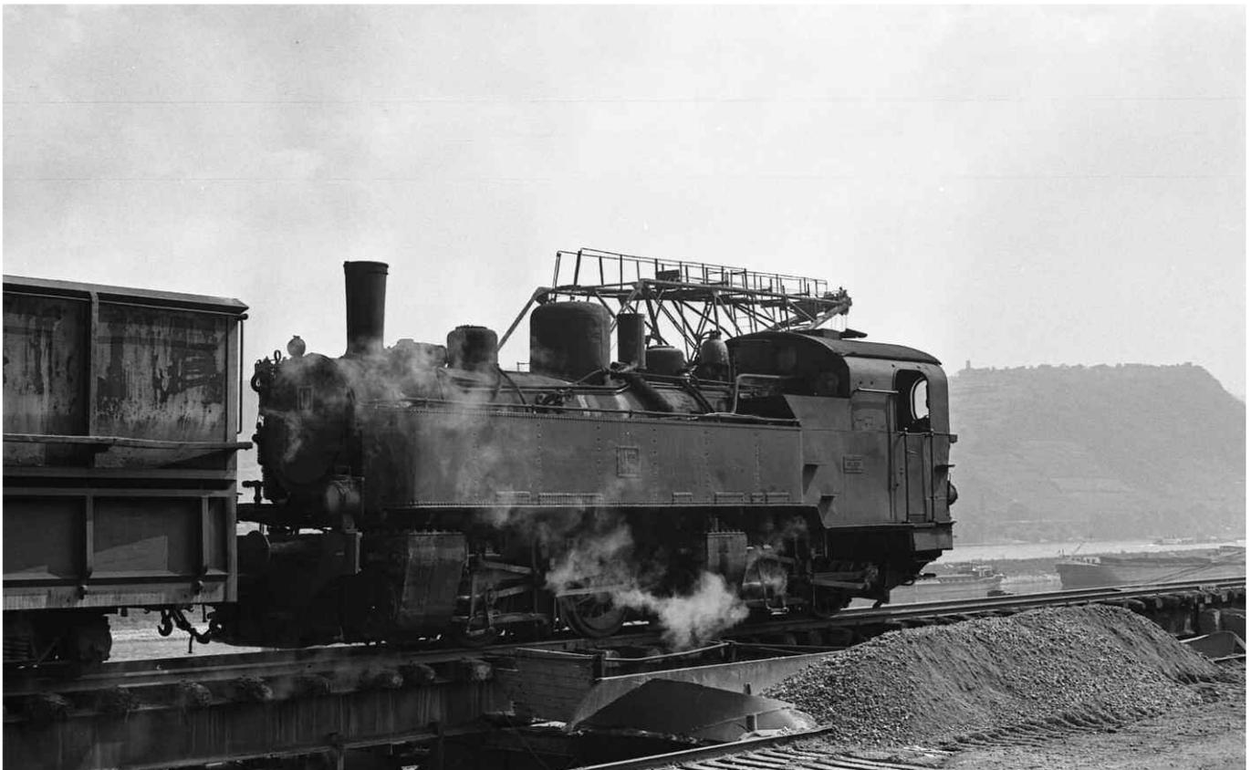
▲ Im Hafen wurde die Lok ans andere Zugende rangiert. Hierzu kuppelte man diese im Gefälle zum Kai ab, stellte sie nach Gleis 2 und ließ den Wagenzug anschließend nach Gleis 3 oder 4 ablaufen. Hier steht die 11sm bereits am südlichen Zugende auf der Sturzbunkerbrücke (Gleis 1).
