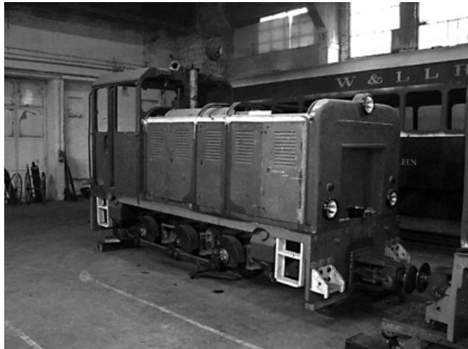
Lok L18H nach Umspurung auf 600mm und mit neuem Catapillar-Motor bei der Fa. CFI in Rumänien (Foto: Georg Hocevar, CFI)
