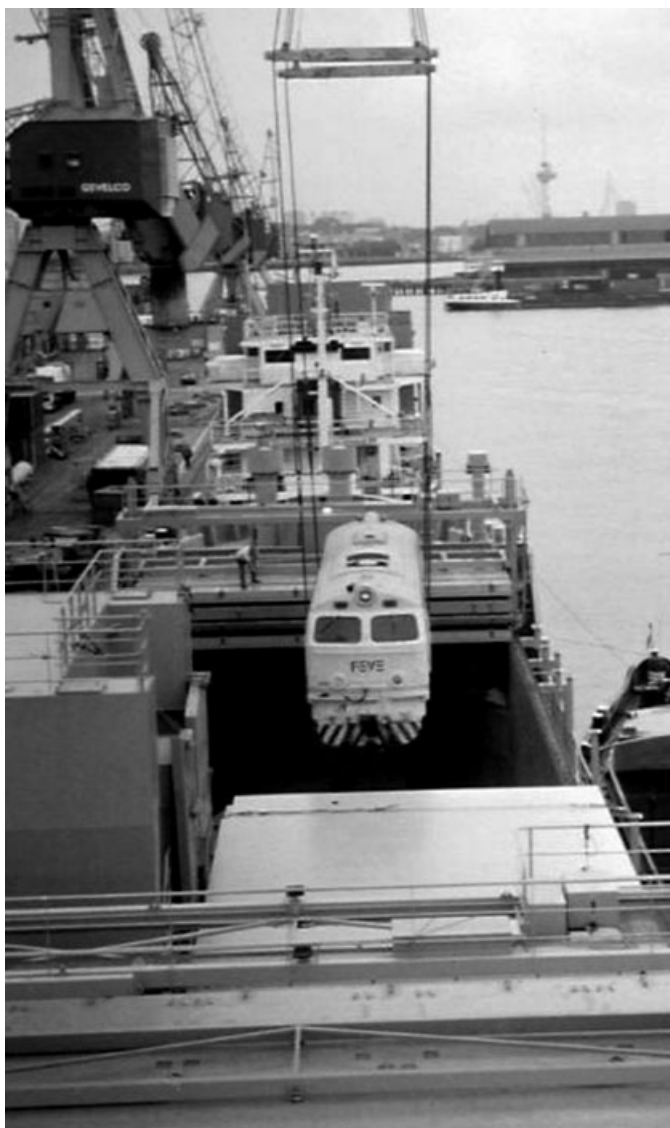
18.08.1998 Rotterdam: Die Lok schwebt am Schwimmkran über der Ladeluke Foto: Dieter Hettler
