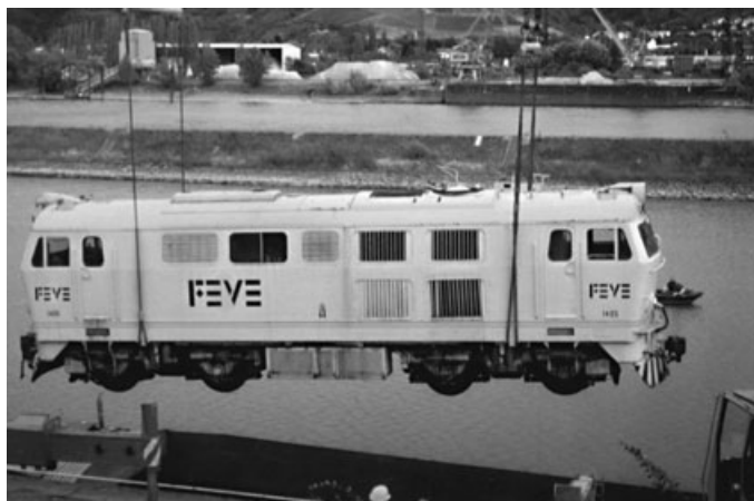
Ankunft in Brohl am 21.08.98: Die Lok an 2 Autokränen über der Pier im Rheinhafen Brohl Foto: Dieter Hettler
