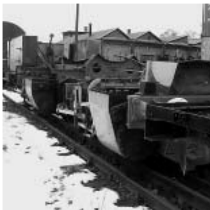
Der Patient ohne Kessel in der Loklinik Klostermansfeld im Februar 2009. Der Zustand auf dem Foto ist bei Redaktionsschluss noch aktuell, da die Lok auf den Kessel aus Pila wartet. Foto: Günther Steinhauer
