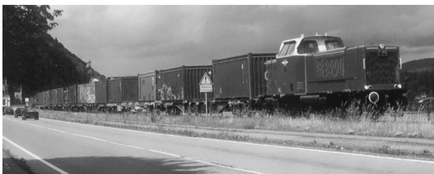
Betrieb auf der Hafenbahn. V 65 mit einem Containerzug für Flußspat.
