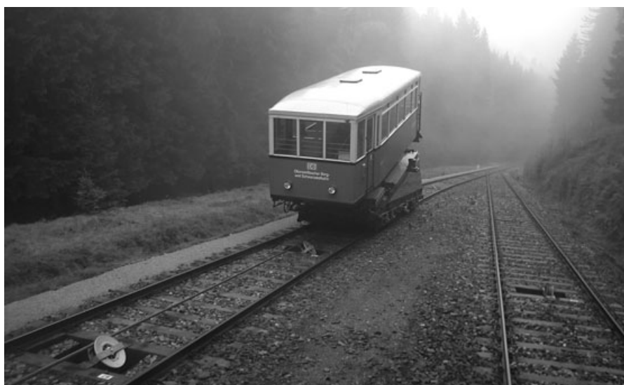
Güterbühne mit Personenwagen der Oberweißbacher Bergbahn. Zum Gewichtsausgleich hängen immer zwei Wagen, die sich an einer Ausweichstelle begegnen, an dem umlaufenden Seil. Vorn links ist eine Seilführungsrolle sichtbar. Auf die Güterbühne kann auch ein Cabriowagen aufgesetzt werden.
