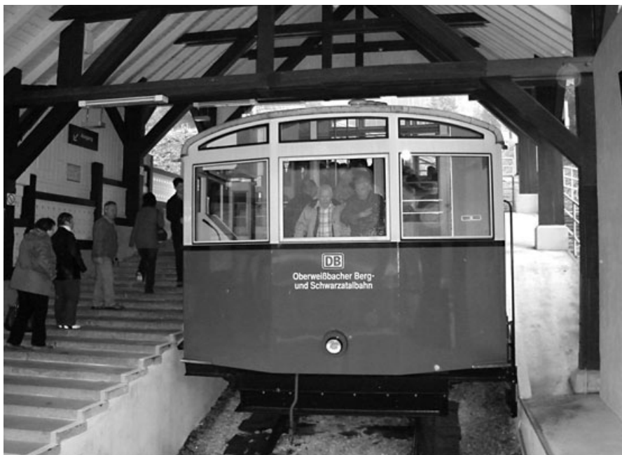
Der Personenwagen ohne Güterbühne ist für die Neigung entsprechend konzipiert.
