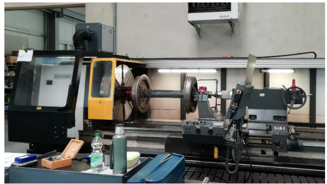
▲ Im Rahmen der Hauptuntersuchung werden die Radsätze der Lok D 2 bei der Firma Limbach Maschinenbau in Mendig auf der Drehbank bearbeitet. Foto: Andreas Thiel
