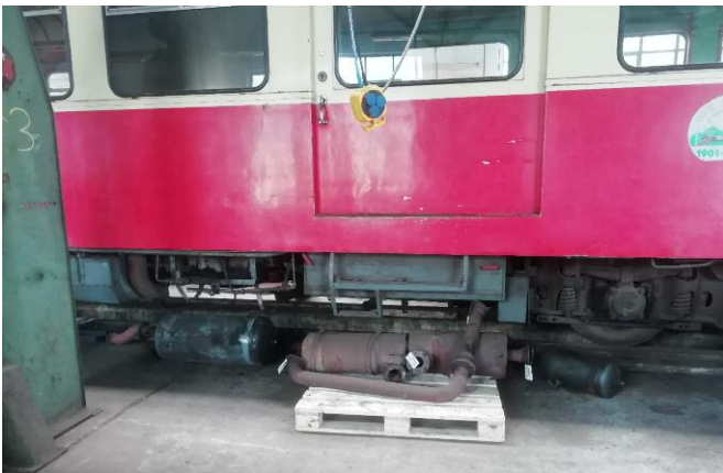
▲ Säuberlich beschriftet, sind die ersten Anbauteile des VT 30 ausgebaut worden. Foto: Stefan Raab
