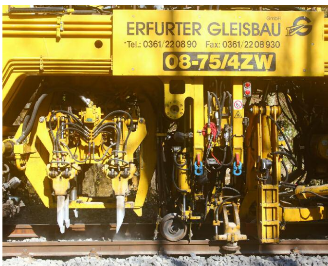
▲ Detailaufnahmen zur Arbeitsweise der Stopfmaschine: Über Führungsrollen an den Schienen erfasst das Gerät die momentane Gleislage und vergleicht diese rechnergestützt mit der Solllage. Erforderlichenfalls wird das Gleis gemäß der Vorgaben angehoben oder in eine Überhöhung gebracht (links). Im nächsten Schritt greifen die Stopfhammer zwischen die Schwellen und verdichten den Schotter unterhalb der Schwellen bis die Solllage des Gleises erreicht ist. Foto: Andreas Adler
