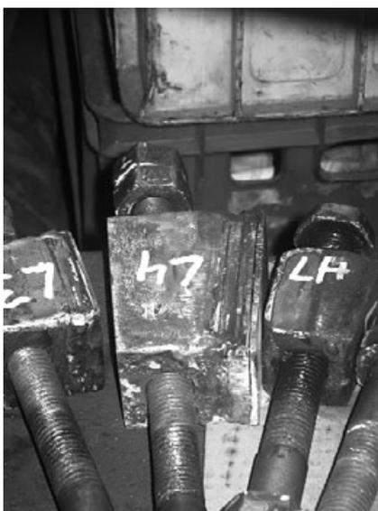
Die Bilder zeigen Frostschäden am Hochdruckschieber (oben), das Vermessen der Kreuzkopfgleitbahnen (Mitte) und die verschlissenen Stangenlager-Stellkeile. Viele Teile müssen neu gefertigt werden.
