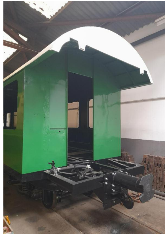
▲ Wagen 32 steht inzwischen wieder auf eigenen Rädern und hat seine Zug- und Stoßvorrichtungen zurückerhalten.
