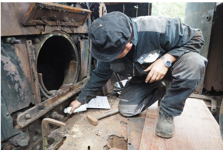
▲ ▼ Mit Ultraschall und Messgeräten hat Pierrick die Wandstärken von Kessel und Feuerbüchse millimetergenau vermessen und protokolliert. Fotos: Michael Baaden
