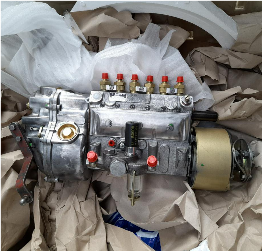
▲ Ende Januar sind erste Motorenteile des VT 30, wie hier eine Einspritzpumpe, aufgearbeitet nach Brohl zurückgekehrt. Foto: Andreas Thiel
