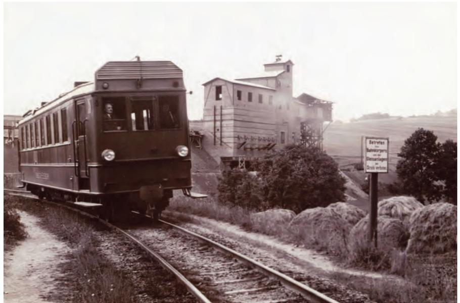
▲ Bild 5: Der 1925 von den Deutschen Werken in Kiel (DWK) gelieferte, 150 PS starke Benzoltriebwagen 50 der Brohltalbahn vor der Kulisse des im gleichen Jahr in Betrieb genommenen Schotterwerks in Oberzissen. Foto: IBS-Archiv
