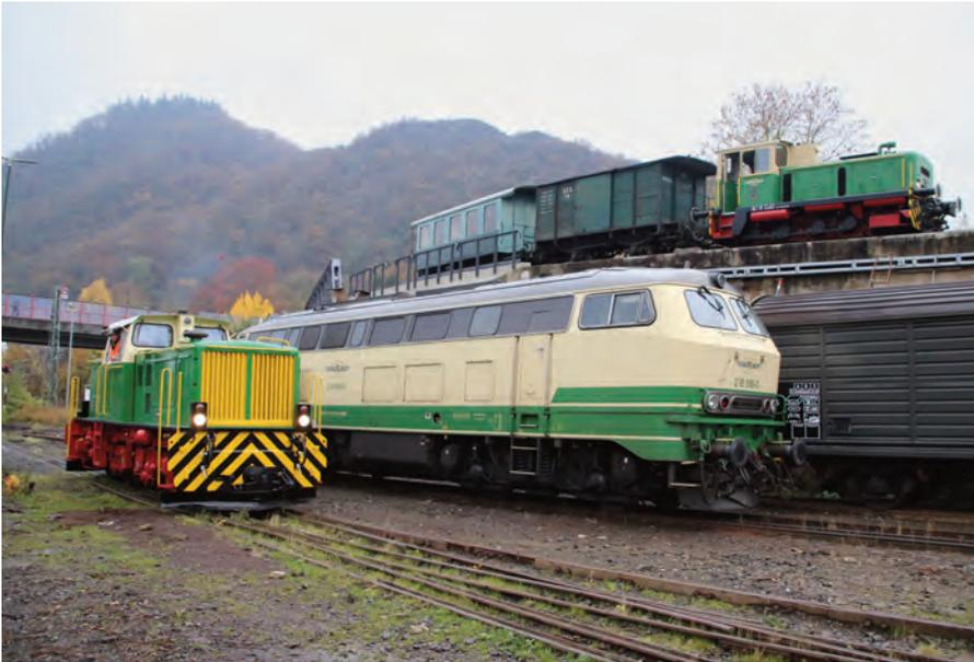
◀ Lok D4 neben der normalspurigen 218 im Umladebahnhof. Der Motor für die Überführung zum Lokschuppen ist bereits an. Oben auf der Rampe ist der zurückkehrende Hilfszug mit D1 erkennbar, welcher die D4 bis zum Stromanschluss gezogen hat.
