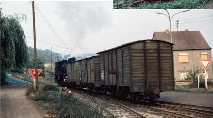
◀ Bahnhof Niederrissen: Lok I ist hier mit drei gedeckten Güterwagen zu sehen. Angesichts dessen, dass keine Zugschlusscheibe erkennbar ist, ist davon auszugehen, dass es sich um eine Rangierfahrt handelt. Interessant ist auch die Gleisanlage mit seinerzeit noch drei Gleisen – auf der Trasse des im Vordergrund sichtbaren Gleises 3 verläuft heute die Geisbergstraße, links ist die steile Waldorfer Straße erkennbar.
