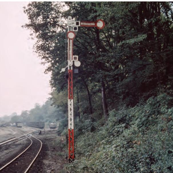
◀ Ortswechsel in den Bahnhof Brohl BE. Dies ist die erste uns bekannte Farbaufnahme des seinerzeitigen Einfahrsignals, welches von der Hebelbank im Bahnhofsgebäude aus ferngestellt wurde.
