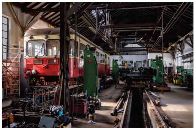
▲ Blick in die Werkstatt am 02. März: Links ist der angehobene VT 30 erkennbar, dessen Drehgestelle in der Zwischenzeit aufgearbeitet worden sind. Der Wagenkasten wartet noch auf seine Sanierung. Rechts ist ein Reservedrehgestell für unsere normalspurige 218 zu sehen.
