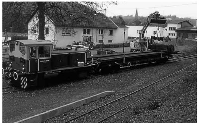
Ebenfalls in Burgbrohl wartet Lok D 2 auf das Ende der Beladung des Flachwagens mit Gleismaterial und Schwellen für den Neubau von 600 m Strecke.
