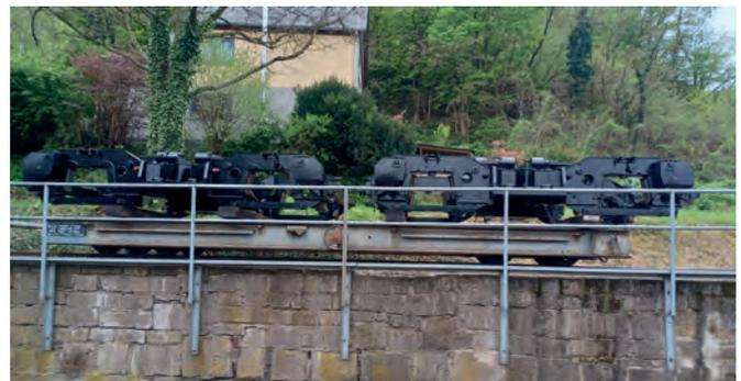
▲ Frisch aufgearbeitet und lackiert präsentieren sich die Tauschdrehgestelle für die 218 am 12. April 2024 auf einem Meterspur-Rollwagen in Brohl. Foto: Stefan Raab
