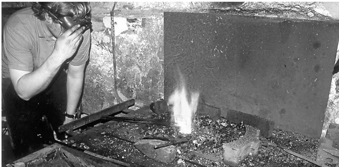
Ehrenamtler Martin Bickenbach am Schmiedefeuer mit einem glühenden Nietnagel für Wagen 109 (siehe auch Seite 16)
