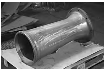
Der neue, solide Schornstein in Gußausführung.
