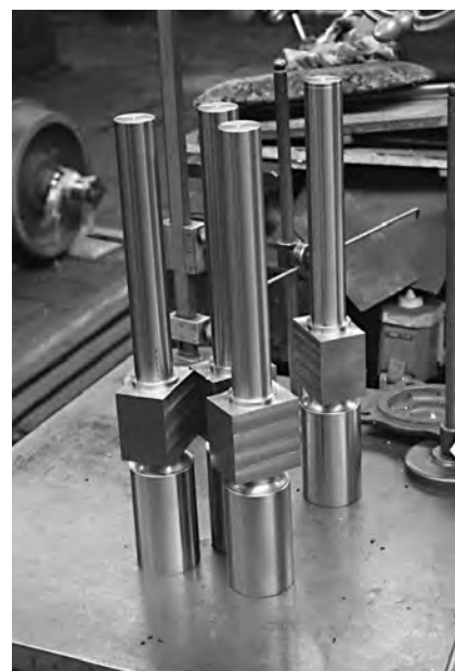
Teilbearbeitete, neue Schieberstangen.
