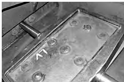
Der Flachschieber vorn links musste neu gefertigt werden.
