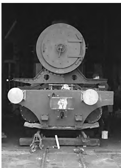
Die schon weitgehend fertig ausgerüstete Pufferbohle.
