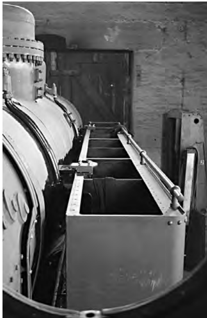
rechter Wasserkasten mit Schwallblechen, noch ohne Abdeckung.
