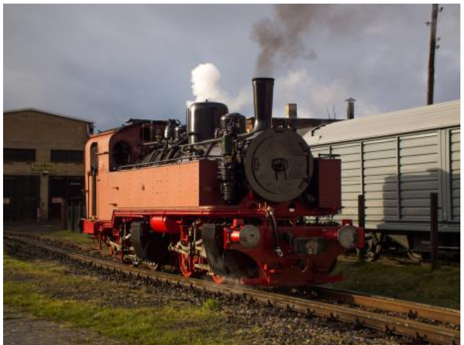
Dampflokomotive 11 sm auf Probefahrt auf dem Probefahrgleis der MaLoWa Bahnwerkstatt. Inzwischen ist auch die Domhaube auf dem Kesselscheitel montiert.
